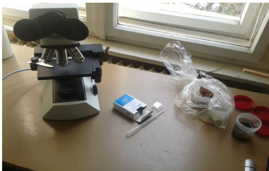
Slika 41: Mikroskop, kapalka, objektno stekelce, krovno stekelce in vzorci
