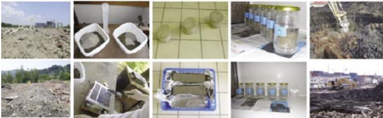
Slika 1: Postopek Stabilizacije/Solidifikacije na s težkimi kovinami onesnaženi zemljini. Foto: Grega E. Voglar, 2008.
