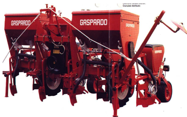
Slika 3.5: Presledna sejalnica z nameščenimi dozatorji mineralnih gnojil
