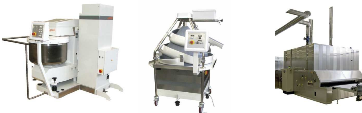
Slika 5: Od leve proti desni: mesilni stroj, stroj za okrogljenje testa, tunelska peč (Gostol, 2010)
