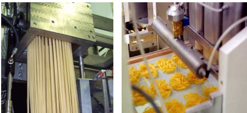
Slika 9: Oblikovanje testenin: desno potiskanje skozi modele – ekstrudiranje, levo oblikovanje z valjanjem (ITALGI, 2010)
