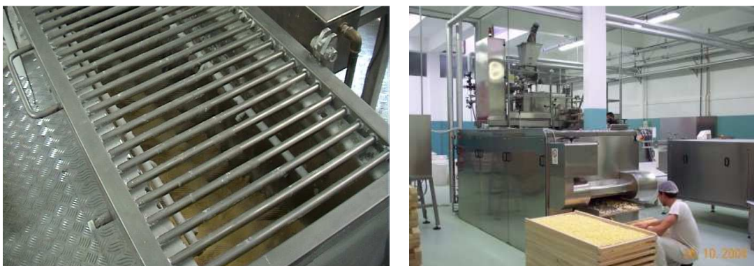
Slika 8: Mešalnik (levo) in sušilnik za testenine (desno) (ITALGI, 2010)
